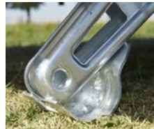
Die Hubstützen sind schwer erreichbar und grob verschweißt. Sie entsprechen aber noch nicht dem Serienstand.
