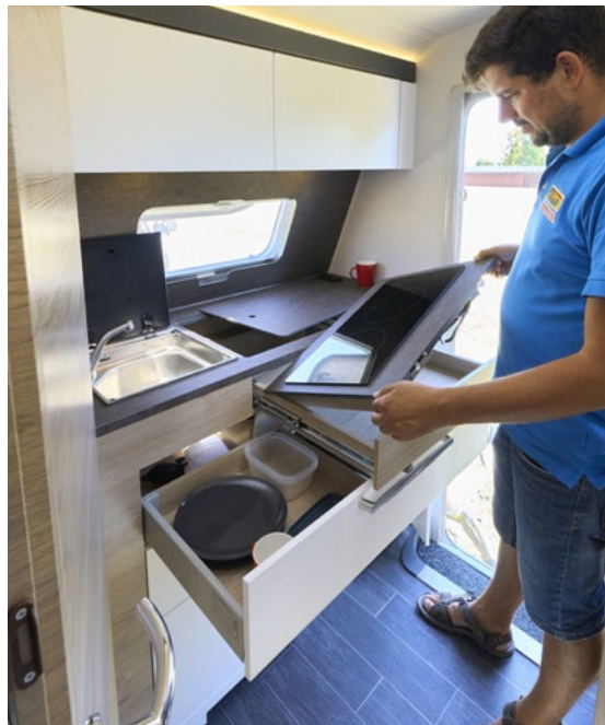
Der Induktionsherd verschwindet nach dem Kochen in einer eigenen Schublade.
