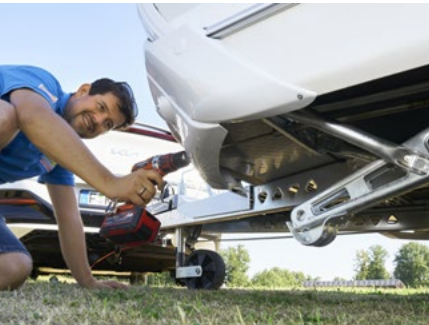
Die Hubstützen sind schwer erreichbar und grob verschweißt. Sie entsprechen aber noch nicht dem Serienstand.
