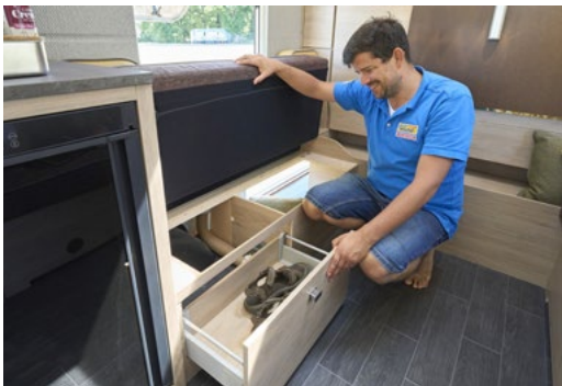
Durch die Schublade bleibt die Hälfte der rechten Sitztruhe auch bei geöffnetem Klappbett erreichbar.
